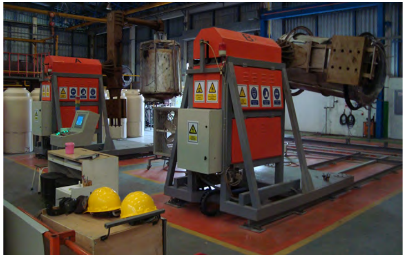
พัฒนาเครื่องจักรแบบให้พลังงานความร้อนแบบปิดประหยัดแก๊ส 2,500 kg/ปี คิดเป็นเงิน 60,000 บาท/ปี
